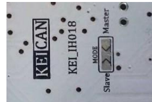
تصویر ۵ جامپر SMD مربوط به تعیین مد در Butterfly M8
